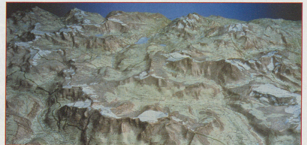
Carte en relief du Mont Blanc obtenue par thermoformage à partir d'un modèle numérique. © IGN
