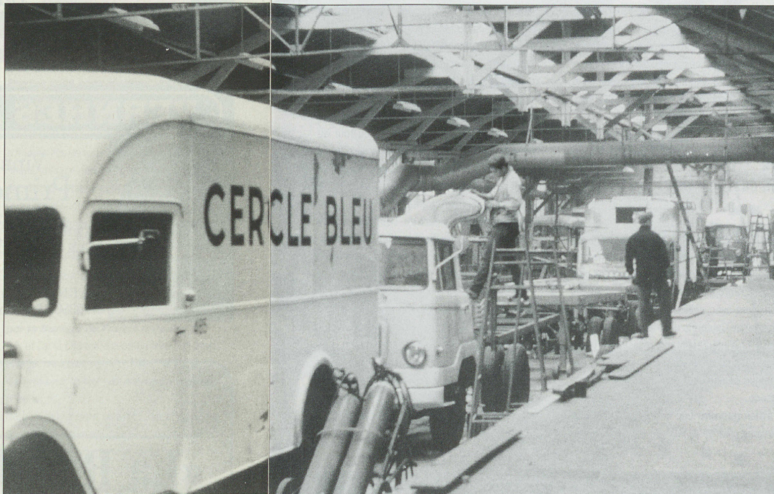
Ci-dessus, la chaîne de montage des camions en 1960. Les châssis venaient de chez Talbot, Renault, Citroën...
