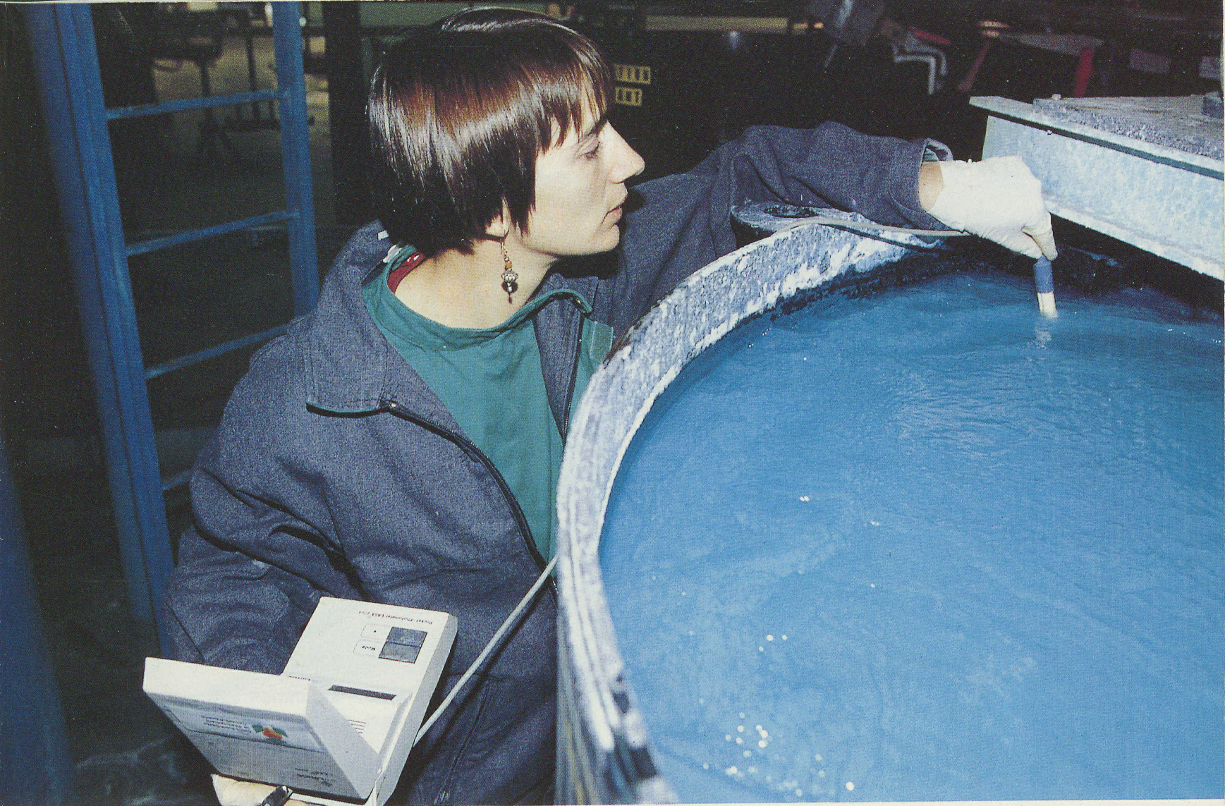
Sophie Genu, technicienne du SATESE, effectue des prélèvements chez ELM-Leblanc, à Bobigny. L'entreprise qui fabrique des chaudières, doit décapier les corps de chauffe. Cette cuve contient le cuivre issu de cette opération.
